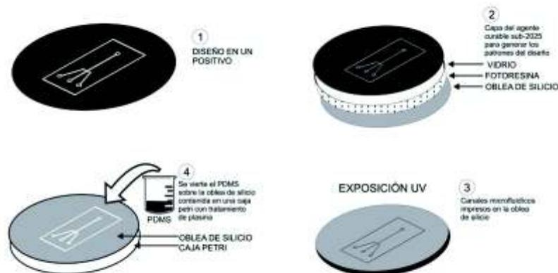
**Figura 14.** Esquema general del proceso de fotolitografía suave para la fabricación del dispositivo MF.
