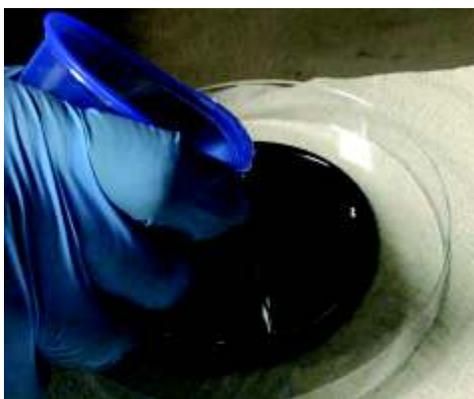
**Figura 11.** Proceso para verter el PDMS y hornear el dispositivo MF.
