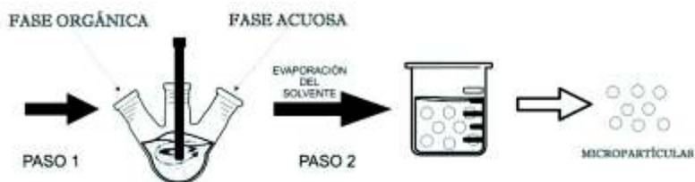
**Figura 3.** Esquema de la técnica de emulsión simple agua / aceite.
