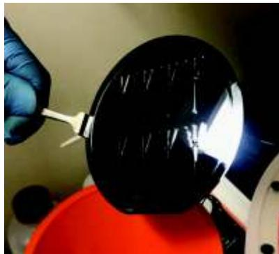
**Figura 10.** Diseño MF impreso por fotolitografía suave en la oblea de Silicio.
