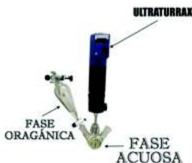
**Figura 6.** Imagen del sistema de agitación Ultraturrax para la preparación de las emulsiones.
