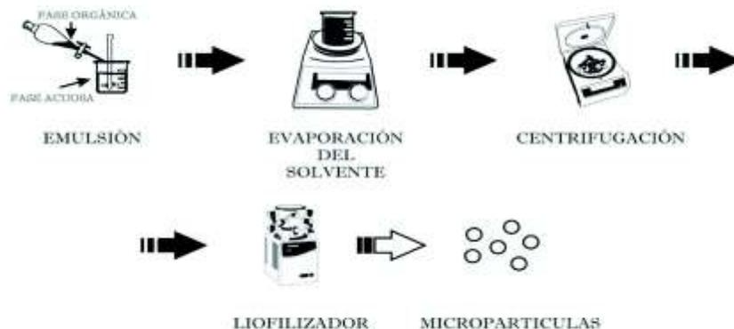
**Figura 7.** Diagrama de flujo para la fabricación de las micropartículas poliméricas.
