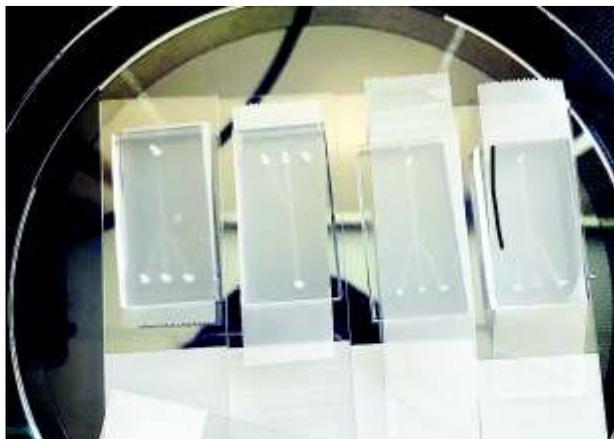
**Figura 34.** Dispositivos microfluídicos fabricados en el laboratorio.
