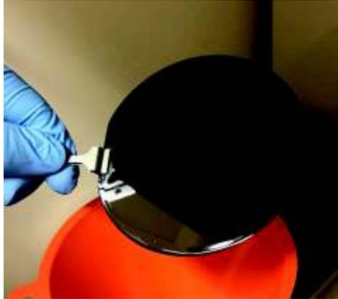
**Figura 8.** Oblea de silicio sometida a limpieza con etanol.
