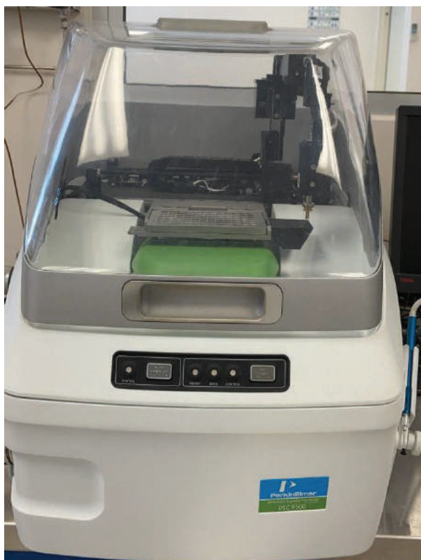
Figura 14. Equipo utilizado para la determinación del análisis de Calorimetría Diferencial de Barrido (DSC), modelo PerkinElmer DSC 8500
