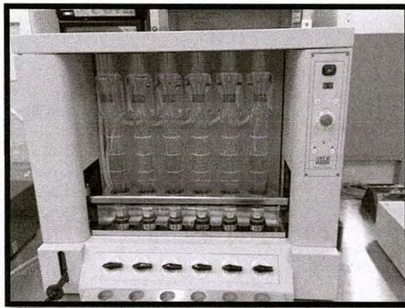
Figura 11. Extracción de fibra cruda de las dietas experimentales.
