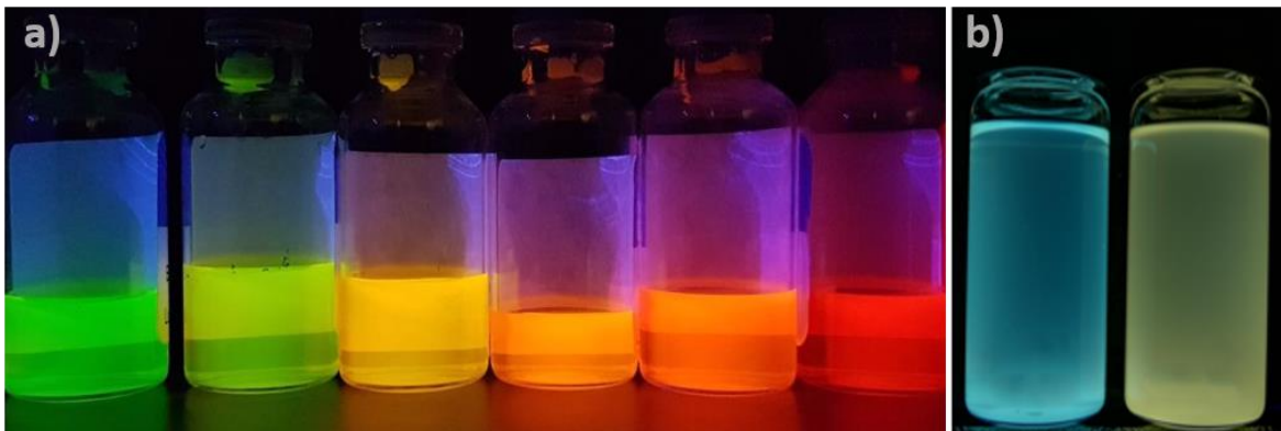
Figura 1.7. Puntos cuánticos de a) CdTe y b) ZnO bajo iluminación ultravioleta, las características de absorción y emisión son dependientes del tamaño de la partícula.
