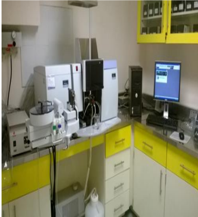
Figura 6. Equipo de espectroscopia de absorción atómica Perkin Elmer AAnalyst 400.
