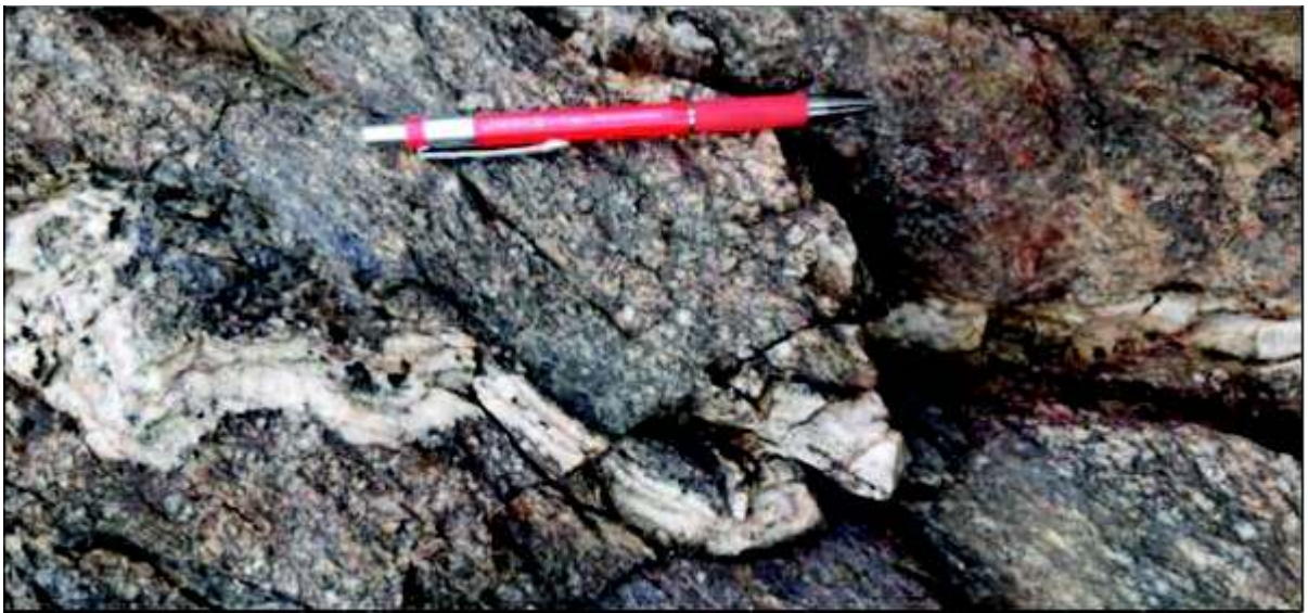
Figura 27.- Indicador cinemático en una zona de cizalla donde se presenta una milonitización de las rocas, el indicador cinemático nos indica el movimiento de la cizalla que es un movimiento lateral compresional sinistral.
