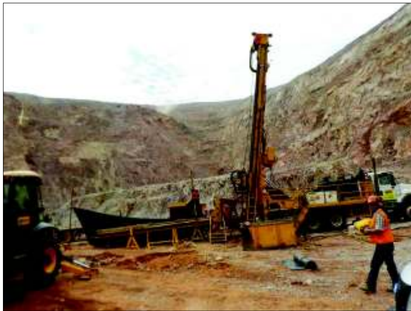
Figura 2. Fotografía mostrando una máquina perforadora de diamante de la empresa Boytec modelo LF-230, instalada en el tajo centauro al SE.
