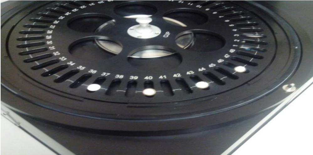
Figura 20. Colocación de los polvos sintetizados en los portamuestras del sistema Risø.
