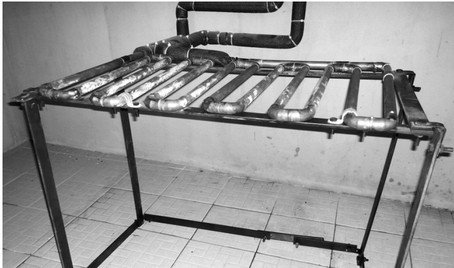
Figura 9. Intercambiador de calor terminado. Fuente: Elaboración propia.
