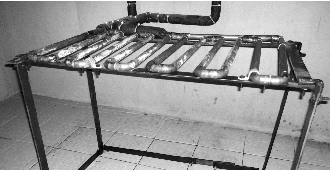
Figura 3. Serpentín intercambiador para la descarga de calor.
