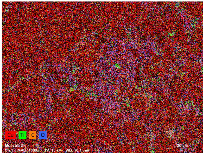
Figura 13. Distribución elemental superficial de la aleación Cu-TiO 2 A.
