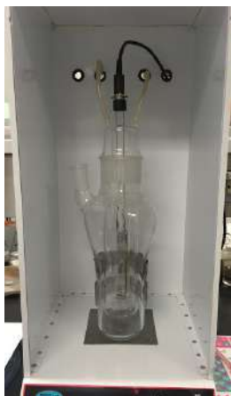
Figura II.3. Reactor para realizar pruebas fotocatalíticas en colorantes.
