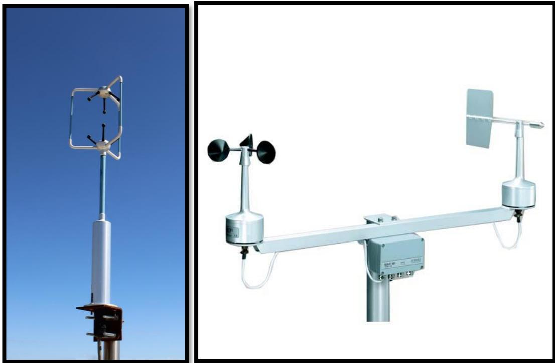
**Figura 6.** Instrumentos de medición utilizados para medir la velocidad y dirección de viento en la PSH. (Izq.) Anemómetro ultrasónico utilizado en la estación 2, (Der.) anemómetro utilizado en la estación
