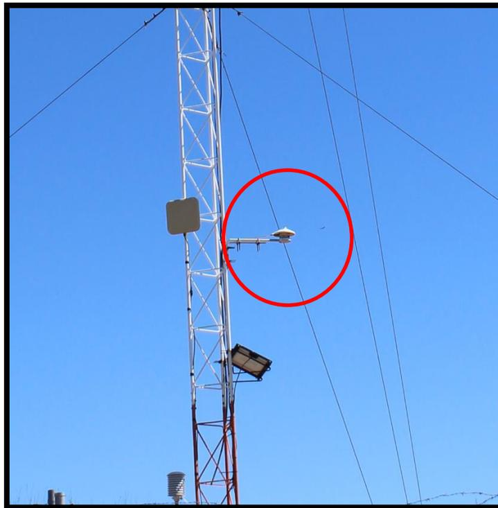
**Figura 11.** Imagen del instrumento medida Piranómetro (Kipp & Zonen) para medir la irradiancia solar en la estación 1.
