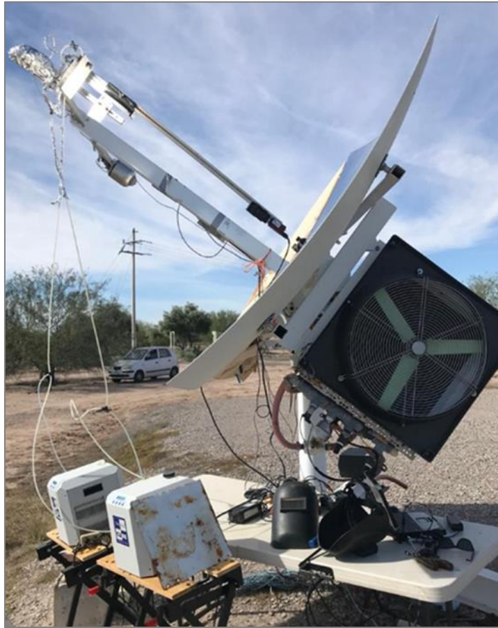
Figura 9. Sistema de Alta Concentración Solar intervenido para la captura de imágenes de la distribución de radiación solar en la zona focal.
