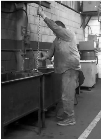
Figura 18. Control de grúa posición incorrecta
