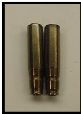
Figura 4. 11. Fixture "PIN" utilizado durante el proceso de moldeo de la pieza
