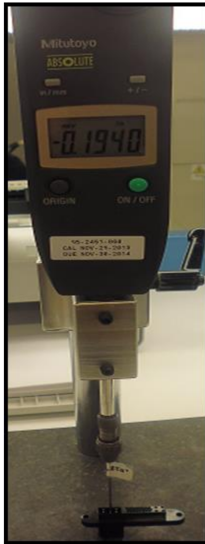
Figura 4. 12. Vernier utilizado para la medición de la altura de los orificios de la pieza
