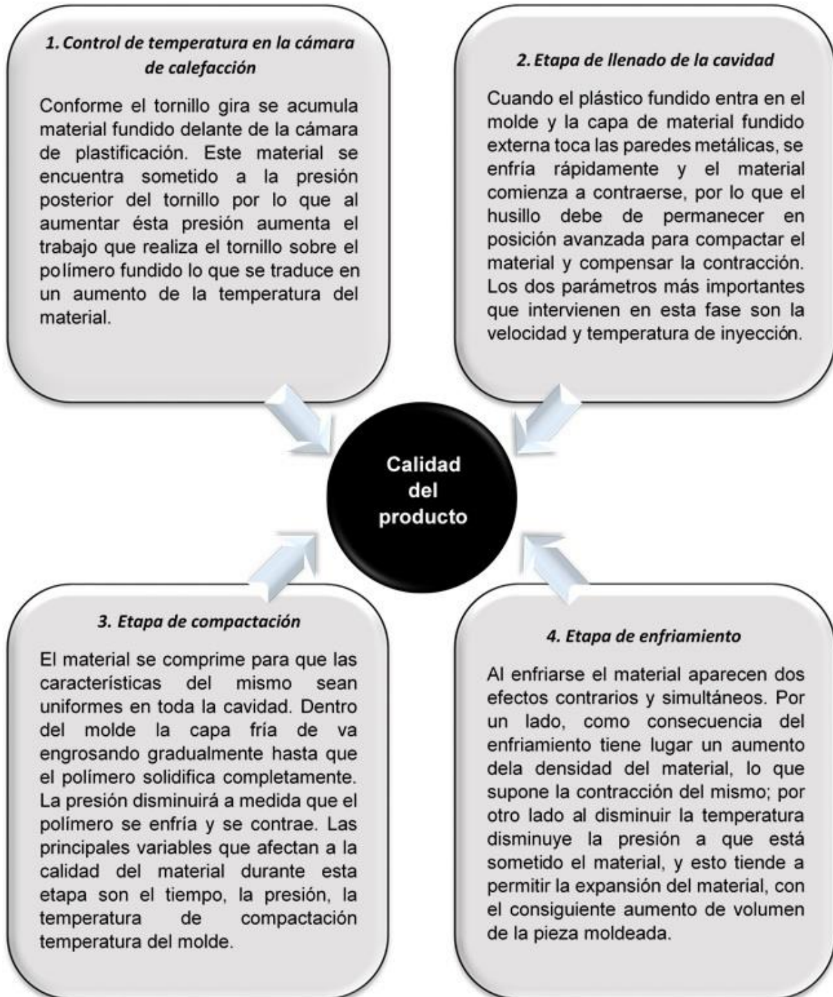
Figura 2. 4. Comportamiento del material dentro del molde (Sánchez, 2002).
