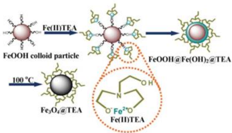
Figura 2.7. Representación esquemática del mecanismo de formación de los nanocristales de \text{Fe}_3\text{O}_4
