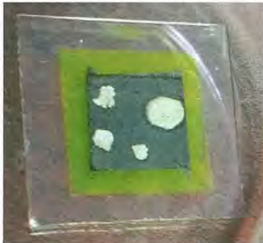
Figura 20. Fotografía del dispositivo fotovoltaico fabricado
