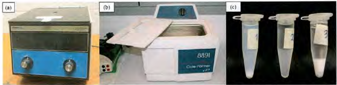
Figura 17. (a) Microcentrifuga Fisher Scientific modelo 59A; (b) Baño ultrasónico Cole-Parmer 8891;
