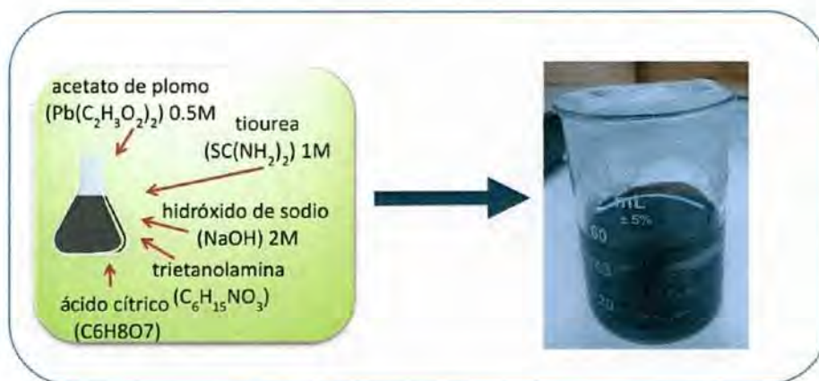
Figura 15. Esquema de la síntesis de nanopartículas de PbS
