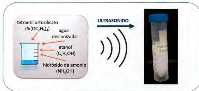
Figura 14. Esquema de la síntesis de nanopartículas de SiO 2 .
