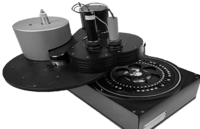
**Figura 10.** *Equipo RISO TL/OSL DA 20, mediante el cual, se llevaron a cabo las mediciones de TL, OSL y AG, para las muestras de aluminato de estroncio, al ser irradiadas por una fuente de emisor de betas (b). Tomado de la referencia [47].*
