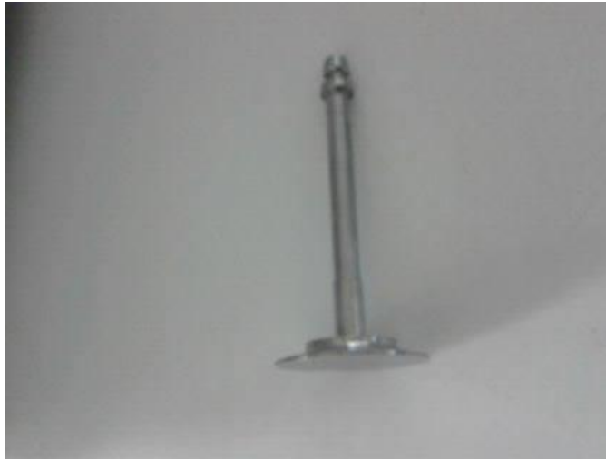
Figura No.3.5.- Geometría Utilizada en el Reómetro para realizar las mediciones
