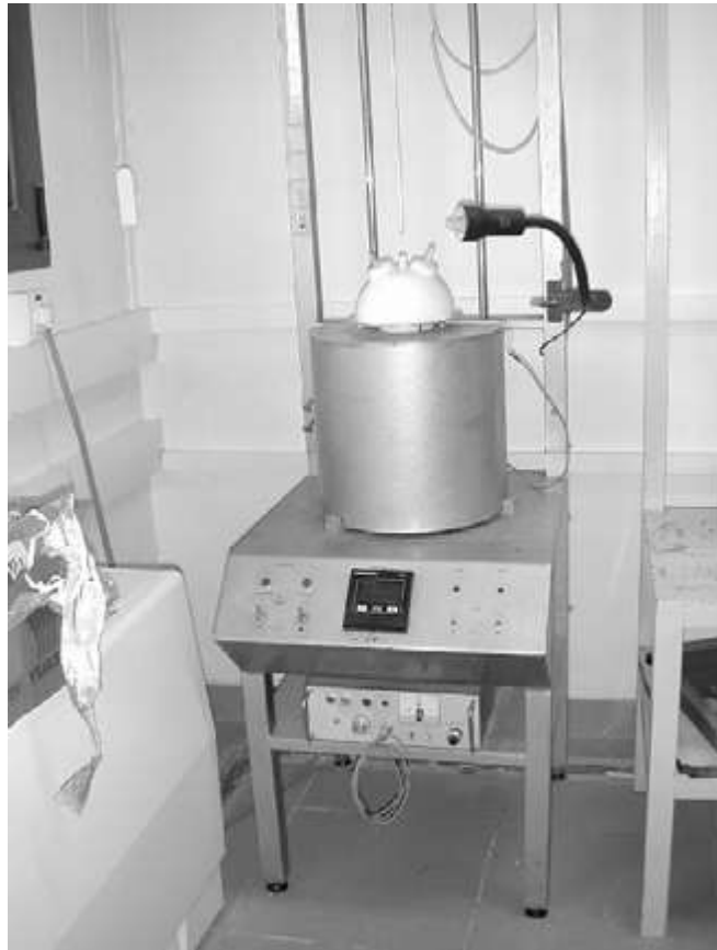
Figura 2.2. Aparato para realizar el crecimiento de un cristal por Czochralski
