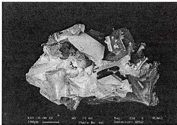
Figura 4.9: Fotografía de un fragmento azul del bulto recocido a 600^{\circ}C , note las formas poliédricas y la fase blanca amorfa
