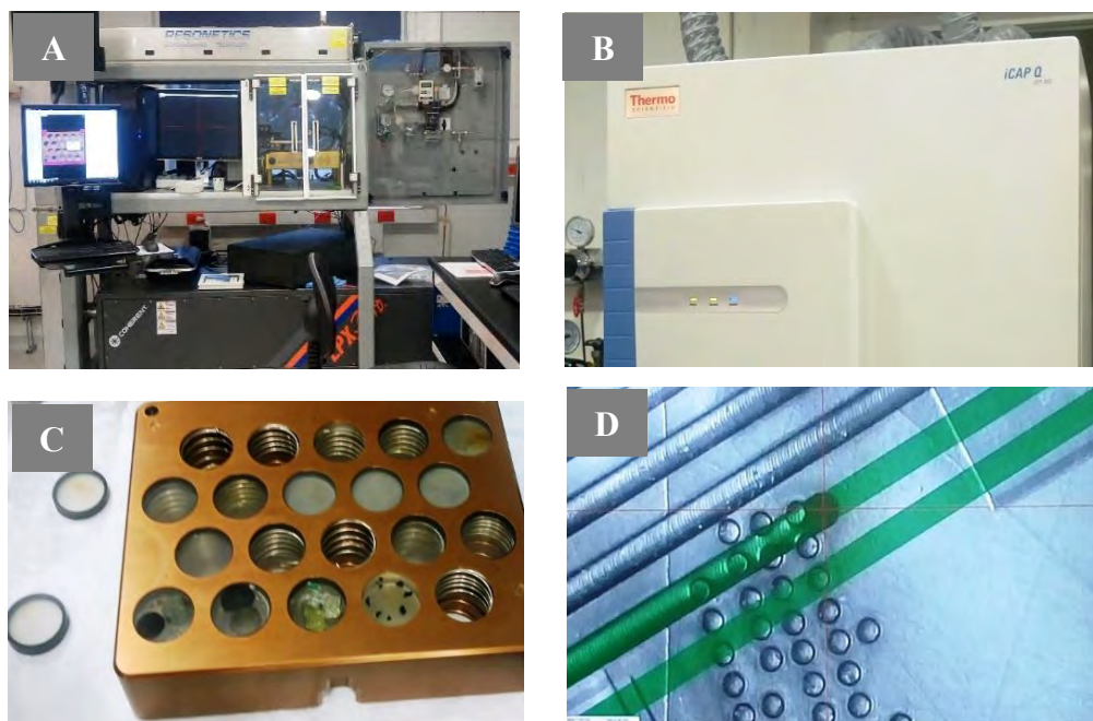
Figura AN4.- Técnica analítica U-Pb. (A) Laser de ablación RESONETICS. (B) Espectrómetro de masas (ICP-MS tipo cuadrupolo). (C) Celdas de ablación con muestras para analizar. (D) Vidrio estándar de referencia ablacionado
