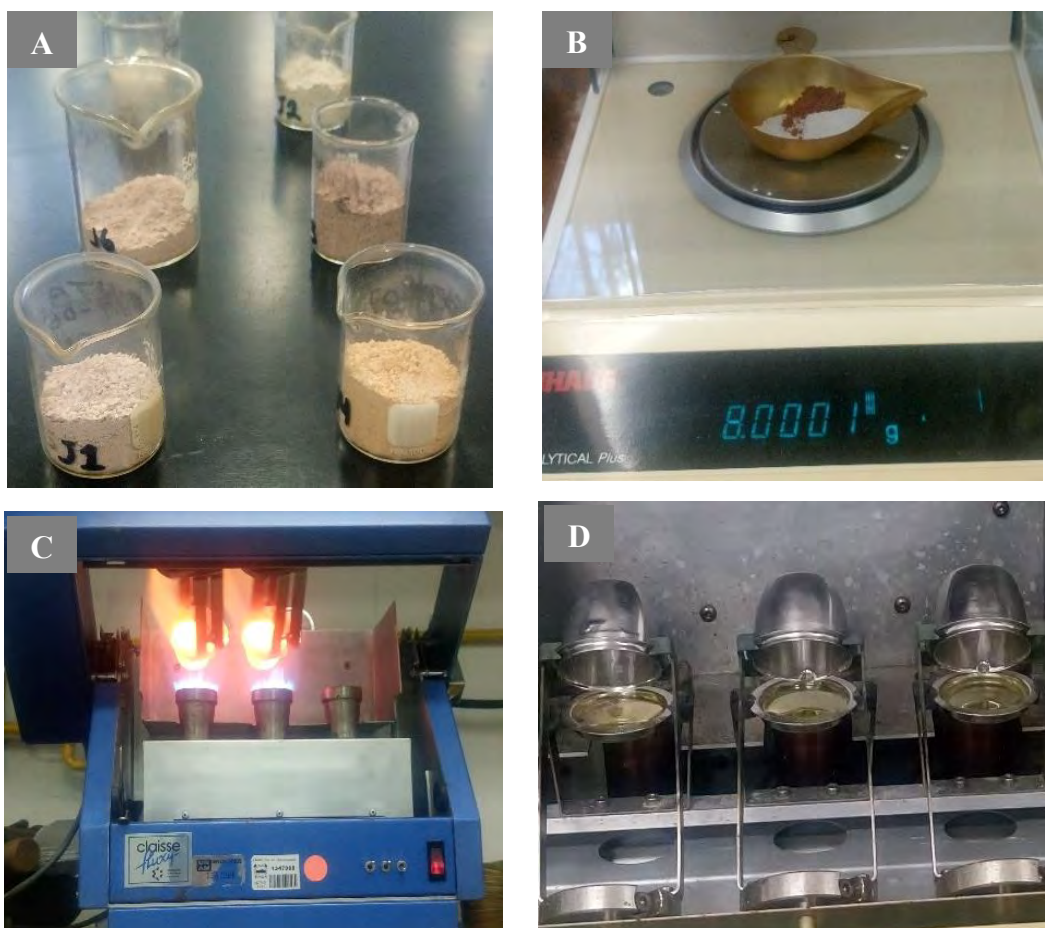
Figura AN2.- Preparación de muestras para elementos mayores. A) 5 gramos de muestra pulverizada en vasos de precipitado. B) Balanza de alta precisión para pesar el fundente. C) Fundidora Fluxy. D) Perlas de vidrio templadas.
