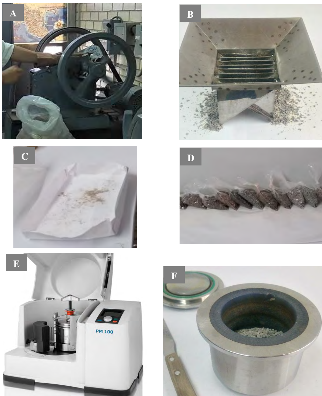
Figura AN1.- Preparación de muestras para análisis de geoquímica. A) Trituradora Braun Chipmunk. B) Cuarteador de gravilla. C) separación manual de intemperismo. D) Obtención de gravilla para pulverizar. E) Molino de bolas PM 100. F) Contenedor de ágata.
