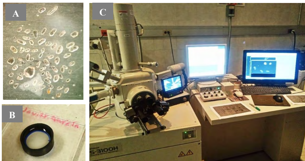
Figura 52. -Preparación de circones antes de ser ablacionados. (A) Elección y organización de circones mediante un microscopio binocular. (B) Circones montados en resina epóxica dentro de una probeta. (C) Microscopio electrónico de barrido (SEM) utilizado para fotografías de circones post-ablación.
