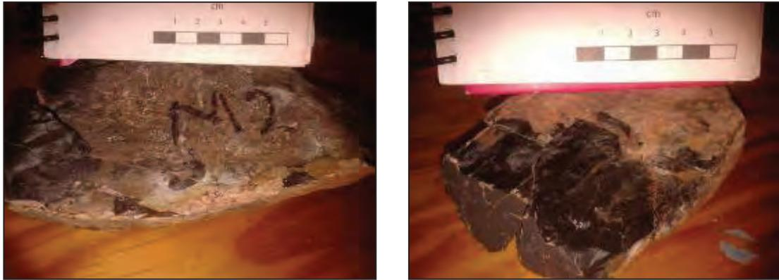
Figura 10.- Fotografías de la muestra M2 de vidrio volcánico tomada en afloramiento.
