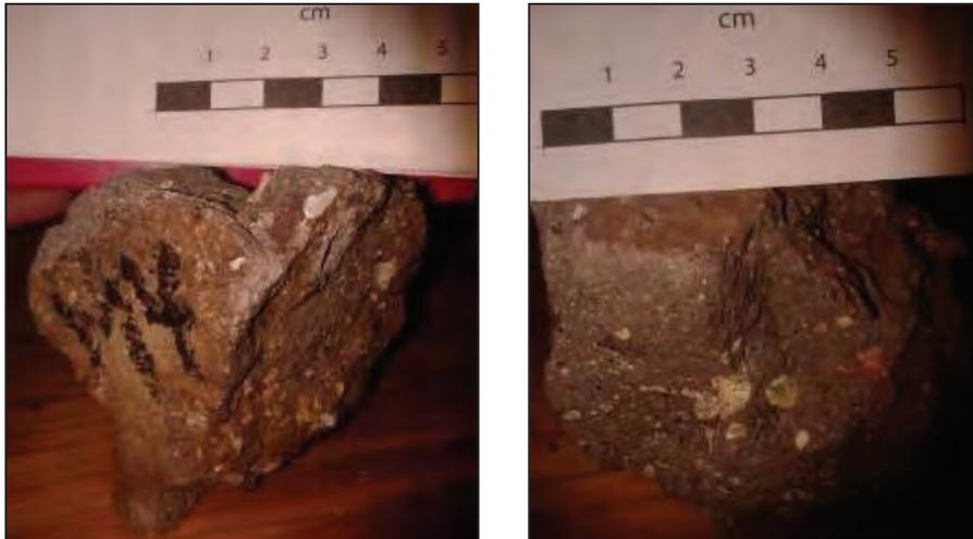
Figura 12.- Fotografía de la muestras M4 de toba riolítica-andesítica tomada de afloramiento.
