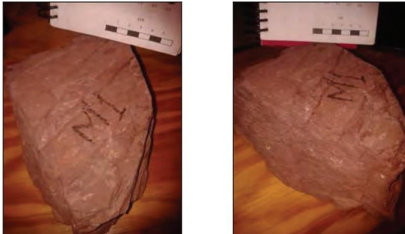
Figura 9.- Fotografías de muestra tomada en afloramiento de toba riolítica.
