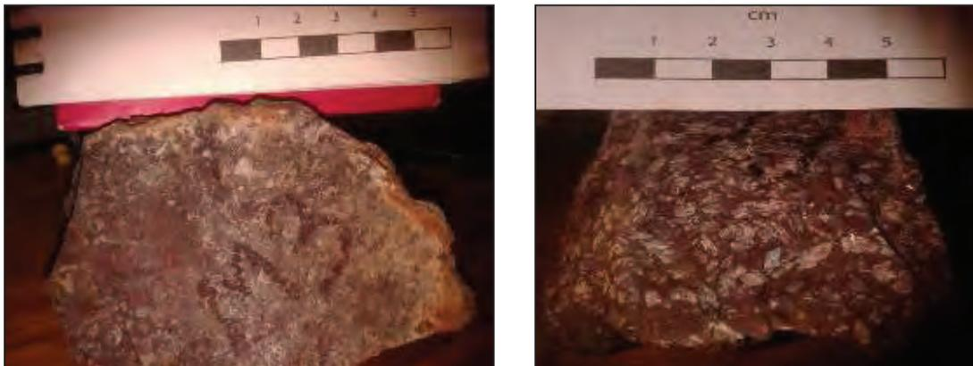
Figura 11.- Fotografías de la muestra M3 de toba riolítica tomadas de afloramiento.
