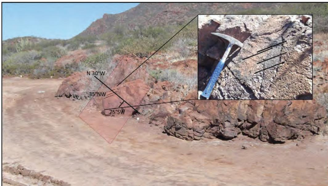
Figura 22.- plano de falla donde se muestra el movimiento del bloque que cae formando el semigraben que da origen a la formación de la cuenca de la laguna La Saladita.
