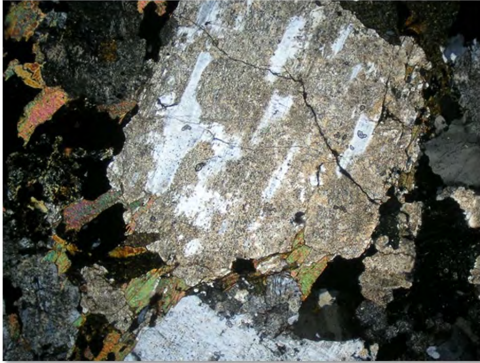
Figura 7. Microfotografía 4X de granito, mostrando cuarzo, plagioclasa de 1 mm de tamaño y pequeños cristales de biotita.
