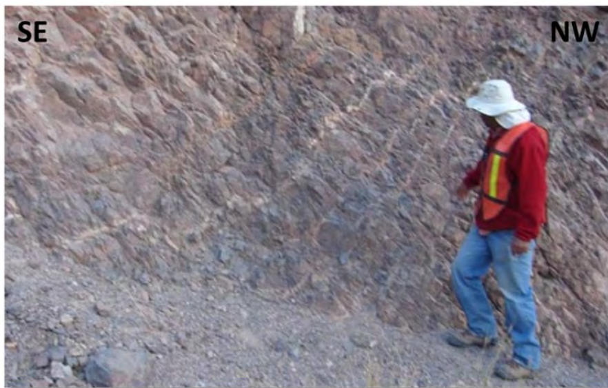
Figura 23. Unidad Dolomía en campo, mostrando vetas de cuarzo con dirección SW20, 60SE.
