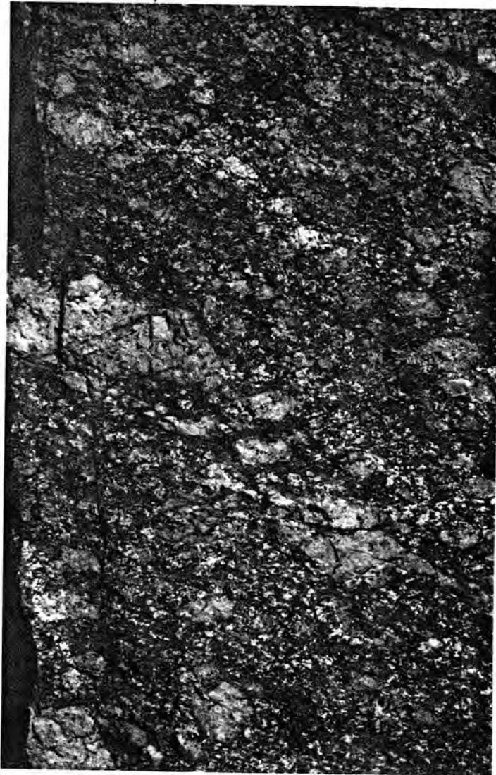
Fig.22.-Fotografía de gneis milonítico proveniente del monzogranito aluminoso precámbrico. Se aprecian grandes cristales de feldespato potásico elongados por los fenómenos de cataclasis. La foliación (S) es marcada por la elongación y recristalización dinámica del cuarzo y la orientación de la biotita y muscovita. Pueden apreciarse las superficies C que separan microlitos milimétricos de feldespato. El sentido de cizallamiento es sinistral. Cañada Bachán viendo al NW. Escala 1:1
