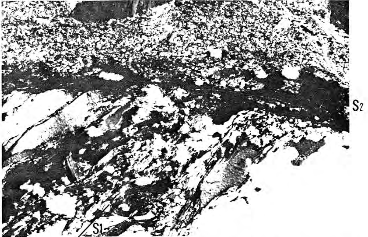
Fig. 45.- Microfotografía de un gneis cuarzo-feldespático proterozoico cuya foliación primaria S1 es marcada por la alineación de los cristales de biotita. Esta foliación es cortada por una foliación milonítica S2 con recrystalización dinámica de cuarzo y de biotita. Escala aprox. 50:1
