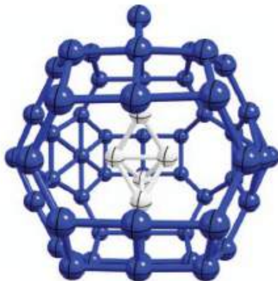
Fig. 4.3.- Nanopartícula bimetalica con estructura de decaedro de Marks decorado en la cintura para la composición \text{Pd}_{58}\text{Pt}_{44} . Los átomos de Pt de la Nanopartícula fueron omitidos. Los 5 átomos de Pd en el interior son mostrados como esferas blancas y los 53 átomos que forman el cascarón externo son representados por las esferas azul oscuro 79 .
