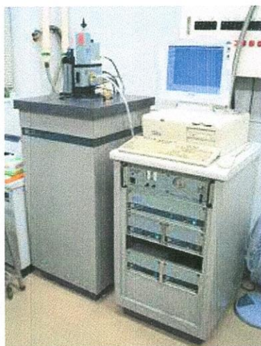
Fig. 13 Quantum Design MPMS. En la parte izquierda se introduce la muestra y la parte derecha es la electrónica que recolecta los datos y programa las mediciones.
