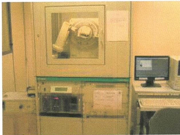
Fig.12 Difractómetro Siemens D5000, dentro de la puerta de vidrio se colocan las muestras, debajo de ello es donde se ingresan los parámetros de la medición y finalmente la computadora colecta los datos
