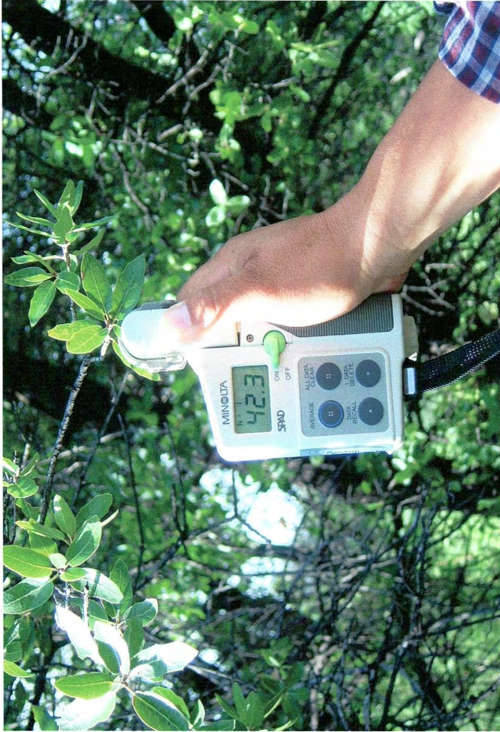
Figura 7. Ilustración del equipo modelo SPAD-502 utilizado para la medición de la clorofila.
