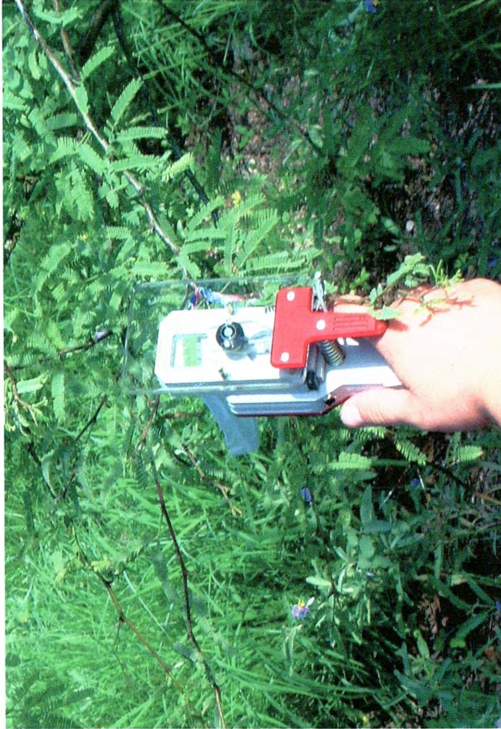
Figura 6. Ilustración de la cámara para hojas anchas utilizada para evaluar variables fotosintéticas.
