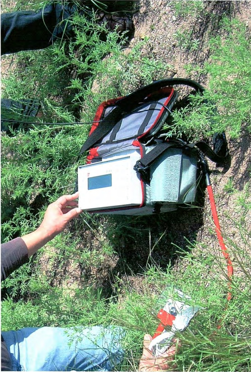
Figura 4. Equipo portátil de fotosíntesis LCA4 ADC con sistema infrarrojo e intercambio abierto utilizado en el estudio.
