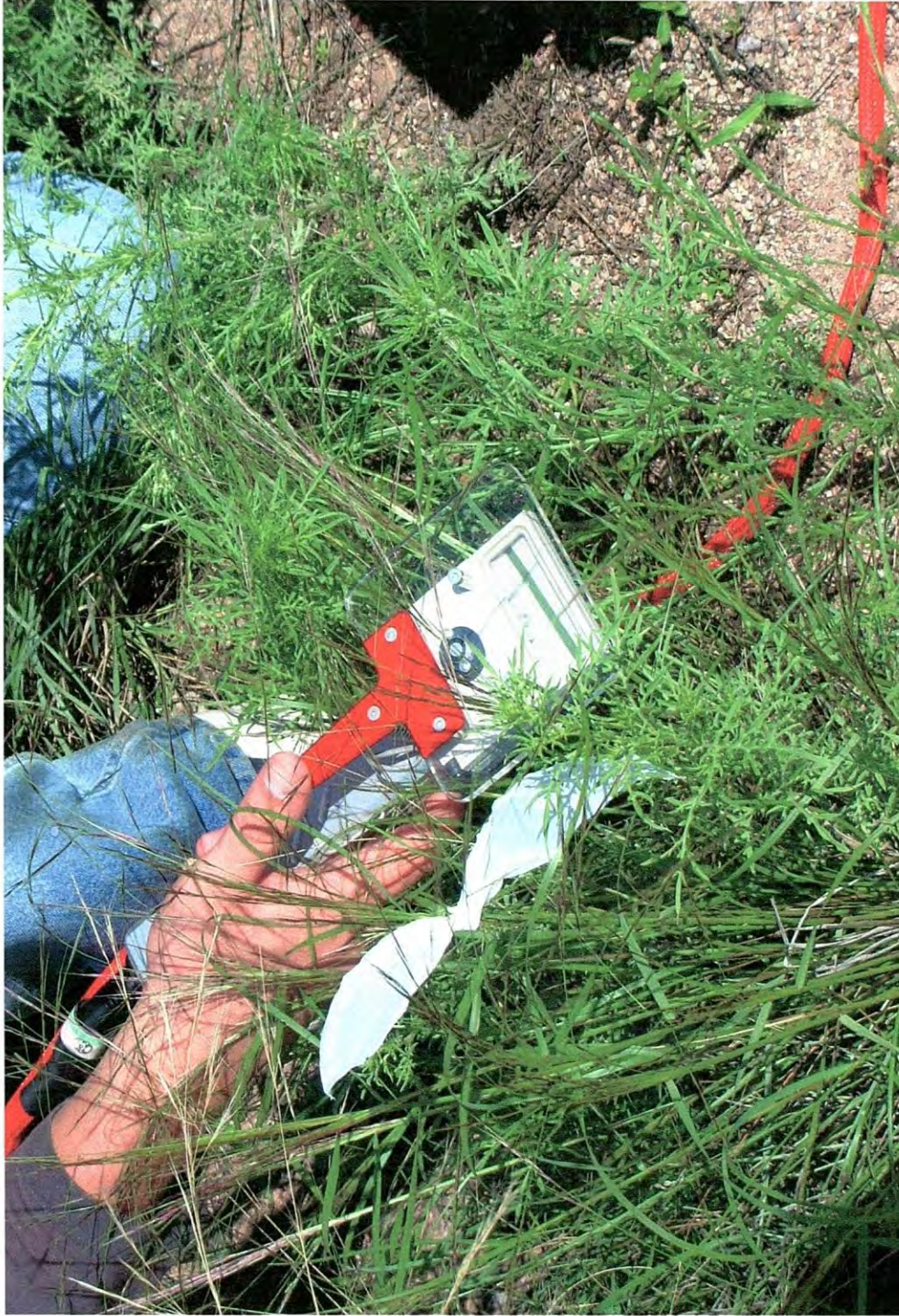
Figura 5. Ilustración de la cámara para hojas angostas utilizada para evaluar variables fotosintéticas.
