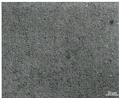
Fig. 6.2 Micrografía obtenida mediante la técnica de DIC de liposomas obtenidos mediante el procedimiento.
