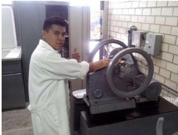
**Figura 25.-** Quebradora de quijadas de acero inoxidable Braun Chipmunk.
