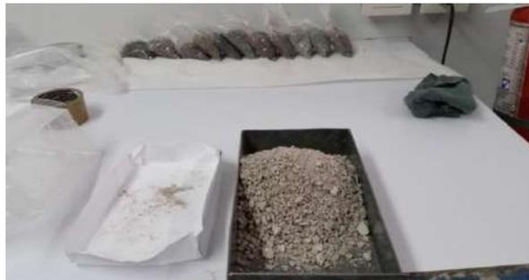
**Figura 26.-** Separación manual de la gravilla obtenida, mediante la trituradora Braun Chipmunk.
