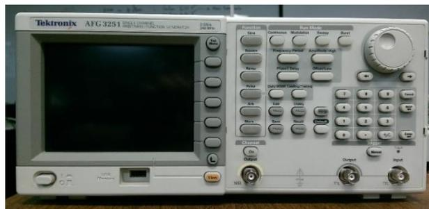
**Figura 3.8** Generador de señal de información, marca Tektronix modelo AFG3251.
