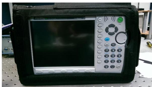
**Figura 3.9** Analizador de espectros de Anritsu.
