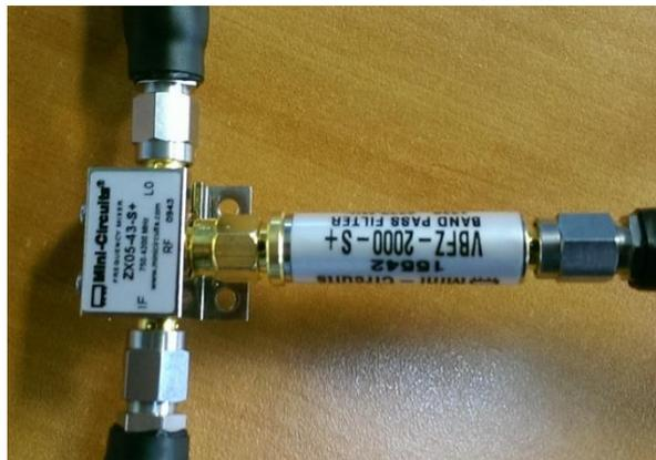
**Figura 3.21** Circuito mezclador + filtro pasa banda armado.
