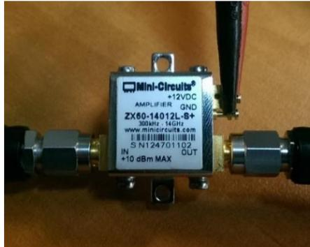
**Figura 3.26** Circuito de tono de RF + amplificador armado
