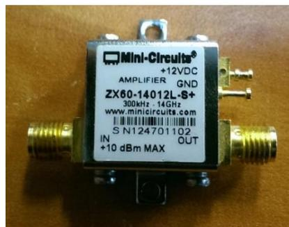
**Figura 3.6** Amplificador de potencia de señales RF [3].
