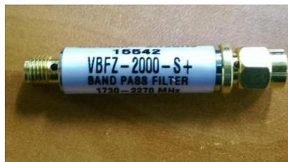
**Figura 3.3** Filtro pasa banda de entrada coaxial.
