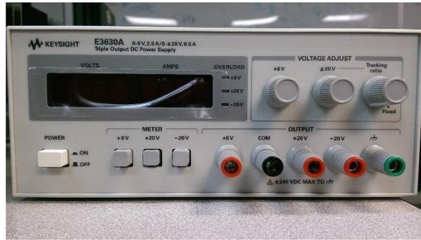
Figura 3.24 Fuente de voltaje de 0-20V.
