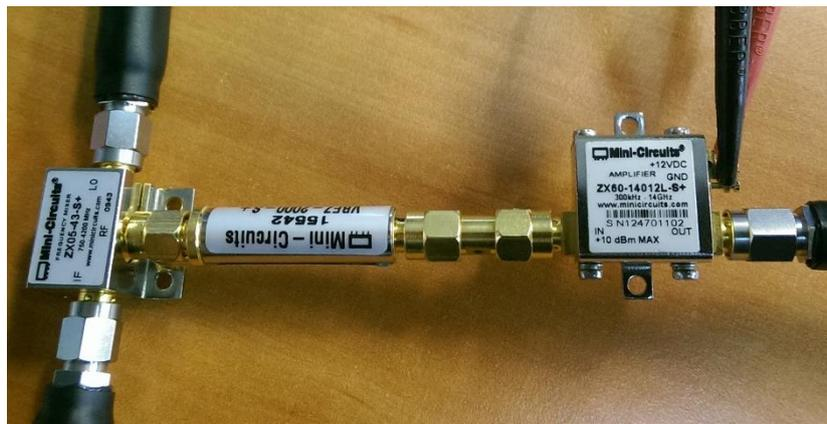
Figura 3.33 Circuito mezclador + filtro pasa banda + amplificador de potencia armado.
