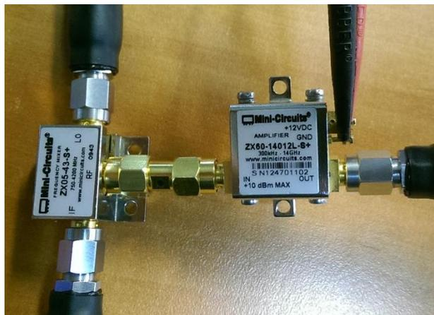
**Figura 3.29** Circuito mezclador + amplificador de potencia RF armado.
