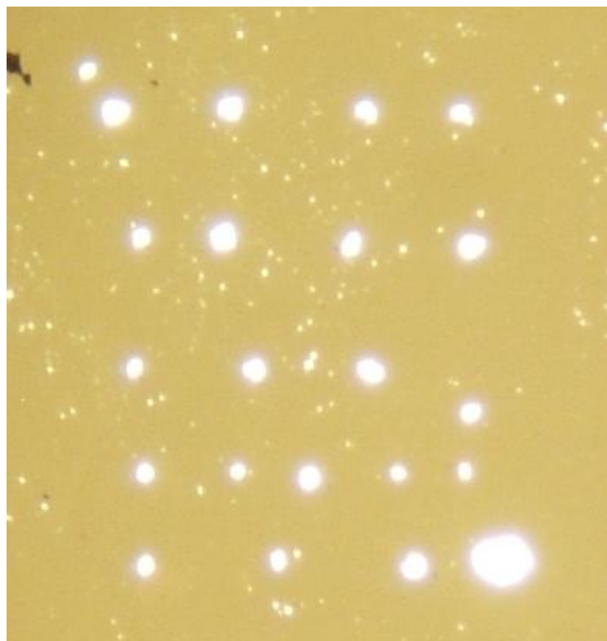
FIGURA 3.7 Película de titanio con microagujeros generados con cavitación
