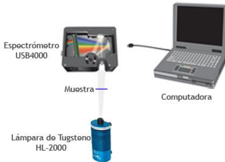
FIGURA 2.4 Arreglo para medir el coeficiente de absorción del \text{Cu}(\text{NO}_3)_2 .
