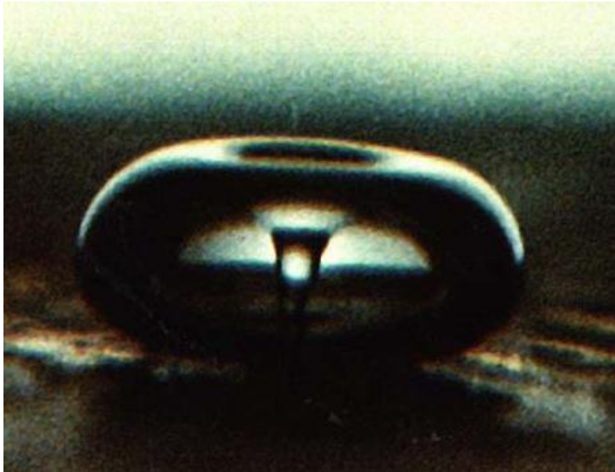
FIGURA 1.3 Burbuja en un líquido irradiado con ultrasonido implota cerca de una superficie sólida. La presencia de sólidos cerca de la implosión genera un colapso asimétrico, formando un chorro de alta velocidad del líquido que afecta a la superficie [11].
