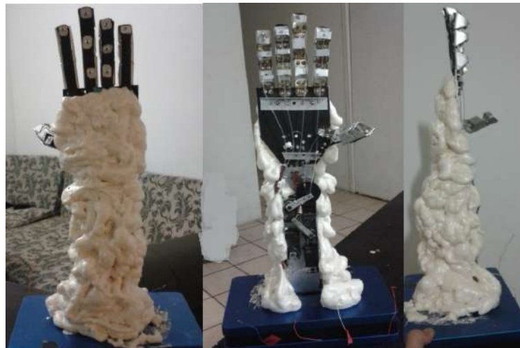
Figura 4.18: Poliuretano en aerosol, utilizado para cubrir y dar forma.
