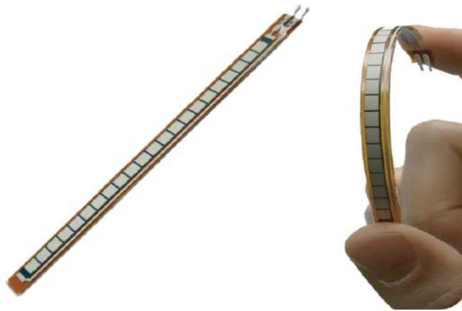
Figura 3.7: Sensor de Flexión. Patentado por "Spectra Symbols". [10]
