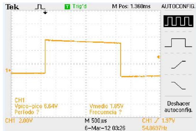
Figura 3.6: Pulso en el osciloscopio del circuito con el flexómetro flexionado.
