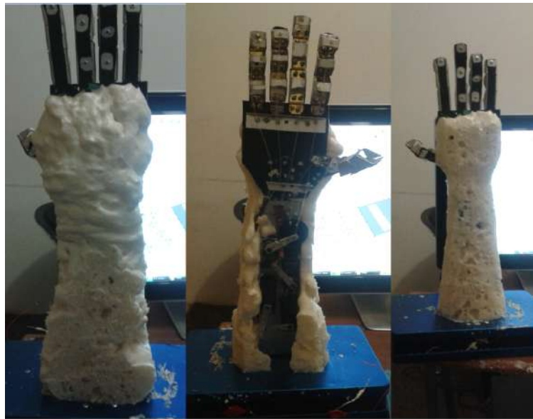
Figura 4.19: Corte y moldeado del poliuretano.
