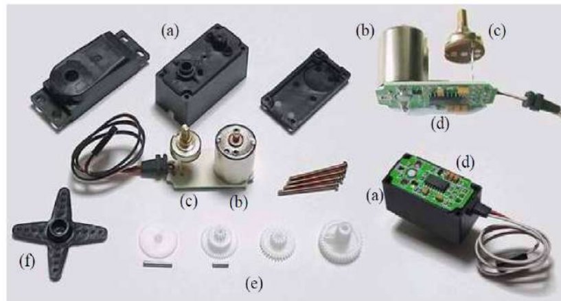
Figura 3.10: Componentes de un servomotor
