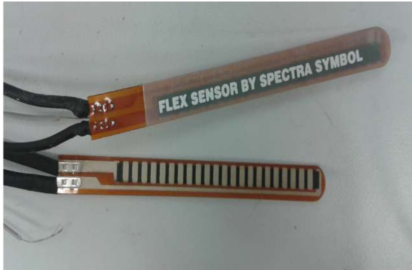
Figura 3.14: Dos sensores de flexión, los cuales le indicarán a nuestra mano la posición de los dedos.
