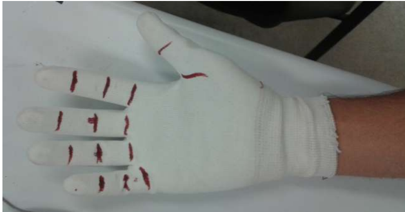
Figura 3.16: Guante donde se ubican los flexómetros, las marcas muestran donde fueron colocados.
