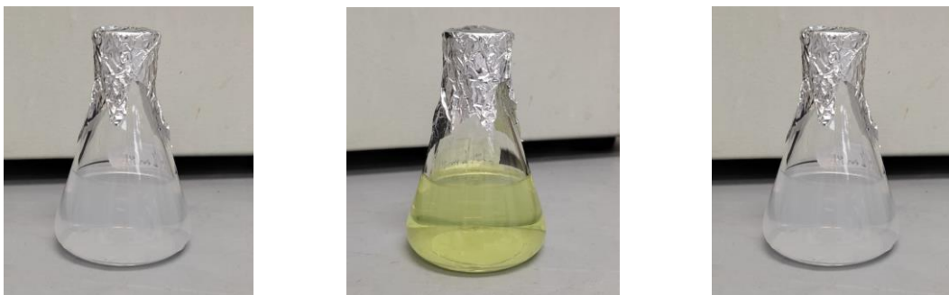
Figura 22 (A) Mezcla de reacción inicial (aldehído + amina), (B) base de Schiff formada, (C) base de Schiff reducida.
