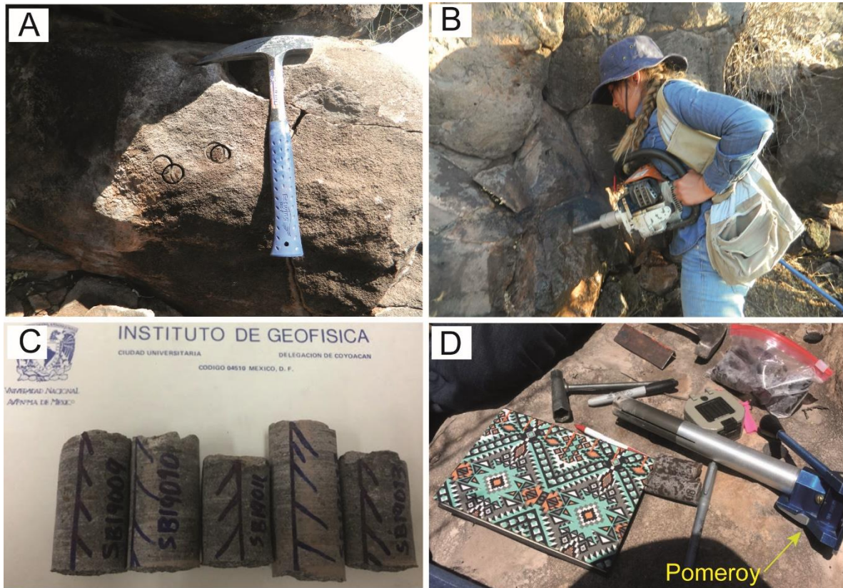
Figura 10. Metodología del muestreo de sitios. A) Perforación de roca basáltica in-situ; B) Técnica de perforación y perforadora portátil de combustión interna, con una broca y corona de diamante; C) Núcleos obtenidos para análisis paleomagnético; D) Herramientas utilizadas para muestreo y orientación de núcleos.
