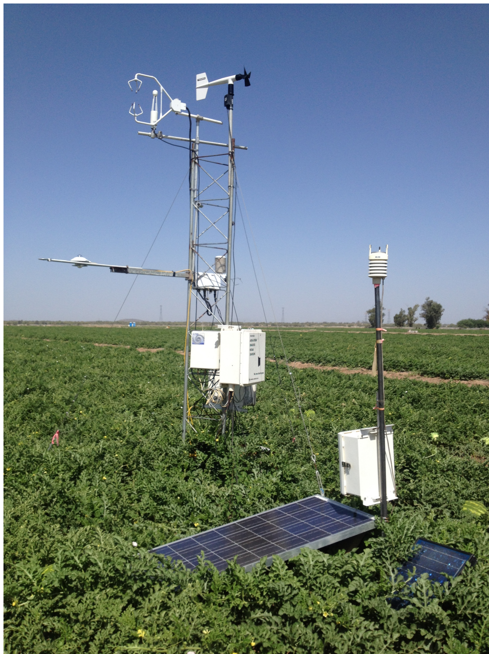
FIGURA 3.3: Estación de covarianza turbulenta, montada en el centro de la trayectoria del cintilómetro
