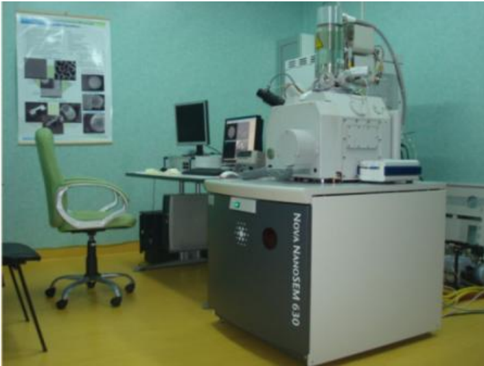
Figura 3.4 Equipo SEM utilizado en la caracterización morfológica de las muestras
