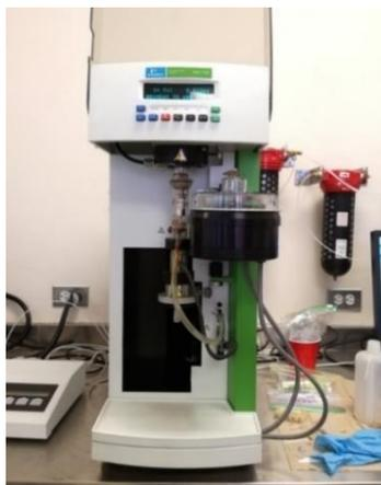
**Figura 23.** Analizador termogravimétrico.
