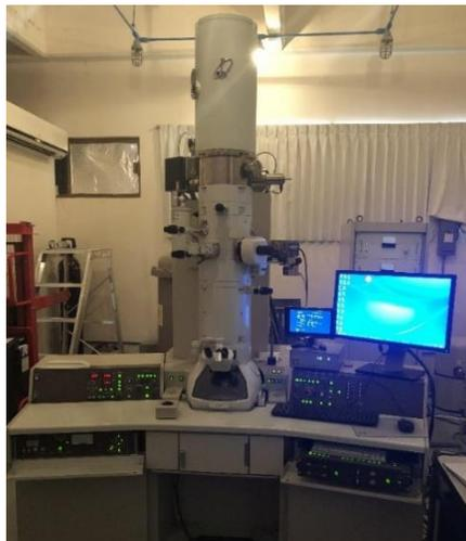
*Figura 21. Microscopio electrónico de transmisión JEM 2010F.*
