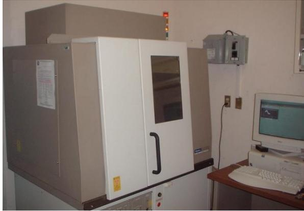
*Figura 25. Difractómetro de rayo X.*
