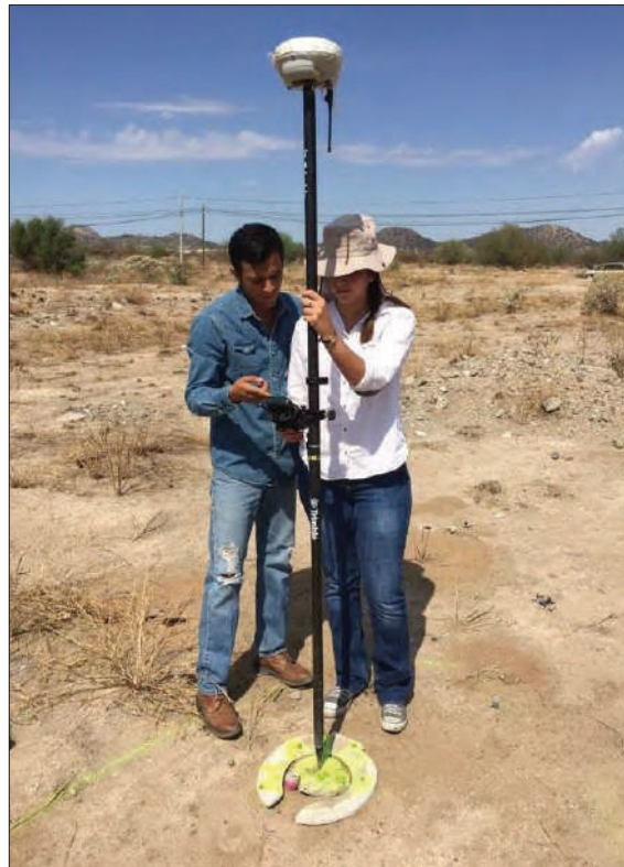
Foto 13. Levantamiento de un punto de control situado en una referencia visible
