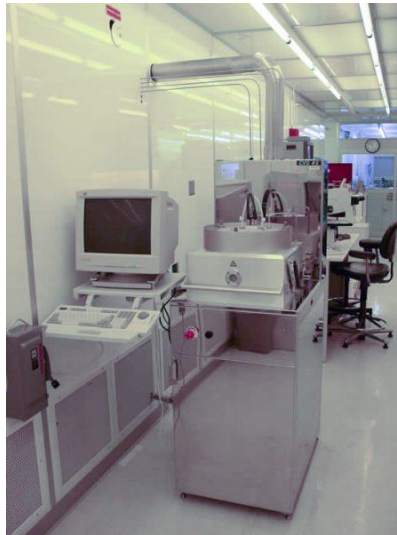
Figura 33. Reactor PECVD modelo Plasma-Therm 790 utilizado para depositar la capa protectora de silicio policristalino sobre las películas de UNCD para su posterior tratamiento térmico.
