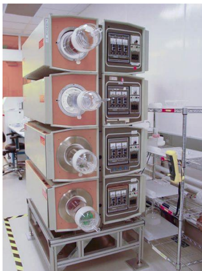
Figura 17. Horno atmosférico marca Minibrute utilizado en los tratamientos térmicos mostrados en esta sección.
