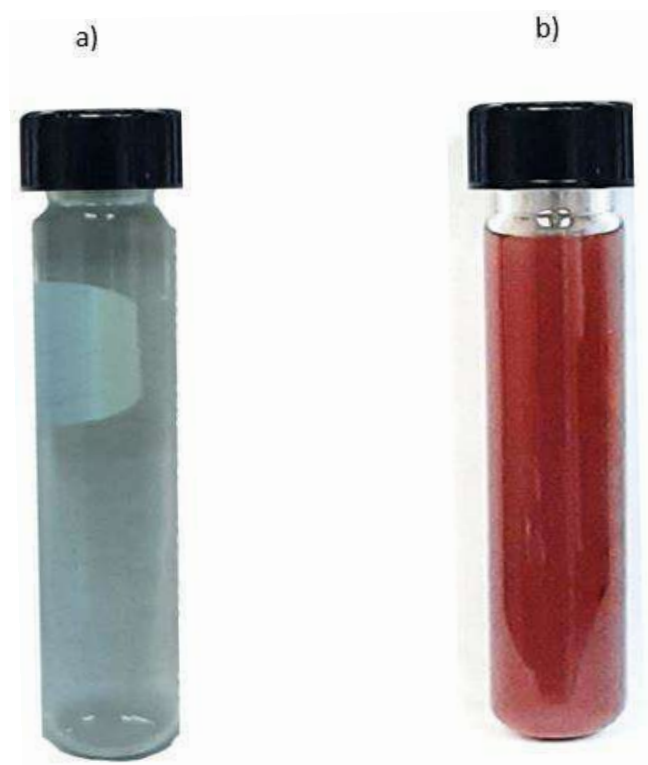
Figura 5.5: Cambio en las tonalidades del nitrato de cobre antes (a) y después (b) de agregar los agentes reductor y acomplexante propuestos en el método de aproximación de síntesis verde.
