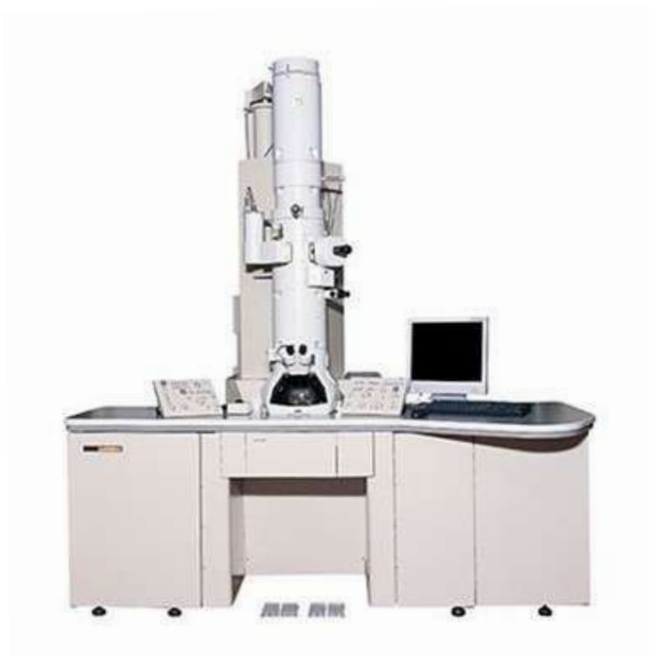
Figura 4.6: Microscopio electrónico de transmisión JEOL JEM-2010.
