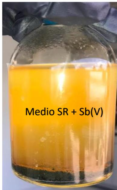
**Figura 7.** Botella con precipitados observables en botella de medio sulfato reductor y Sb(V).
