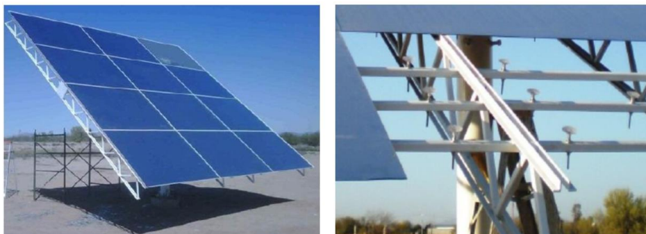
Figura 5. Sistema de sujeción y canteo de espejo del helióstato UNISON-TX-H36 (Rosales, 2014).
