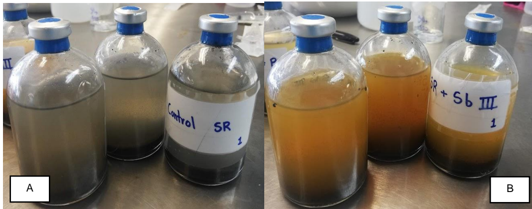
Figura 9. Etapa 3 correspondiente a los experimentos (A) control, sin antimonio y (B) 100 ppm de Sb (III).
