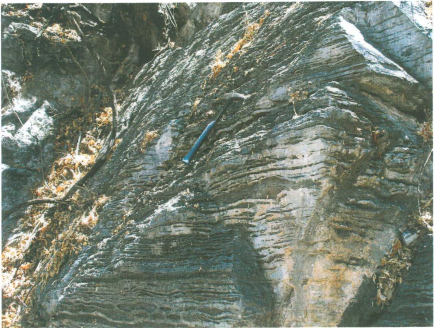
**Fotografía 2.-** Afloramiento de caliza silicificada y recristalizada del Cámbrico-Ordovícico, en la base de la Sierra Martínez.
