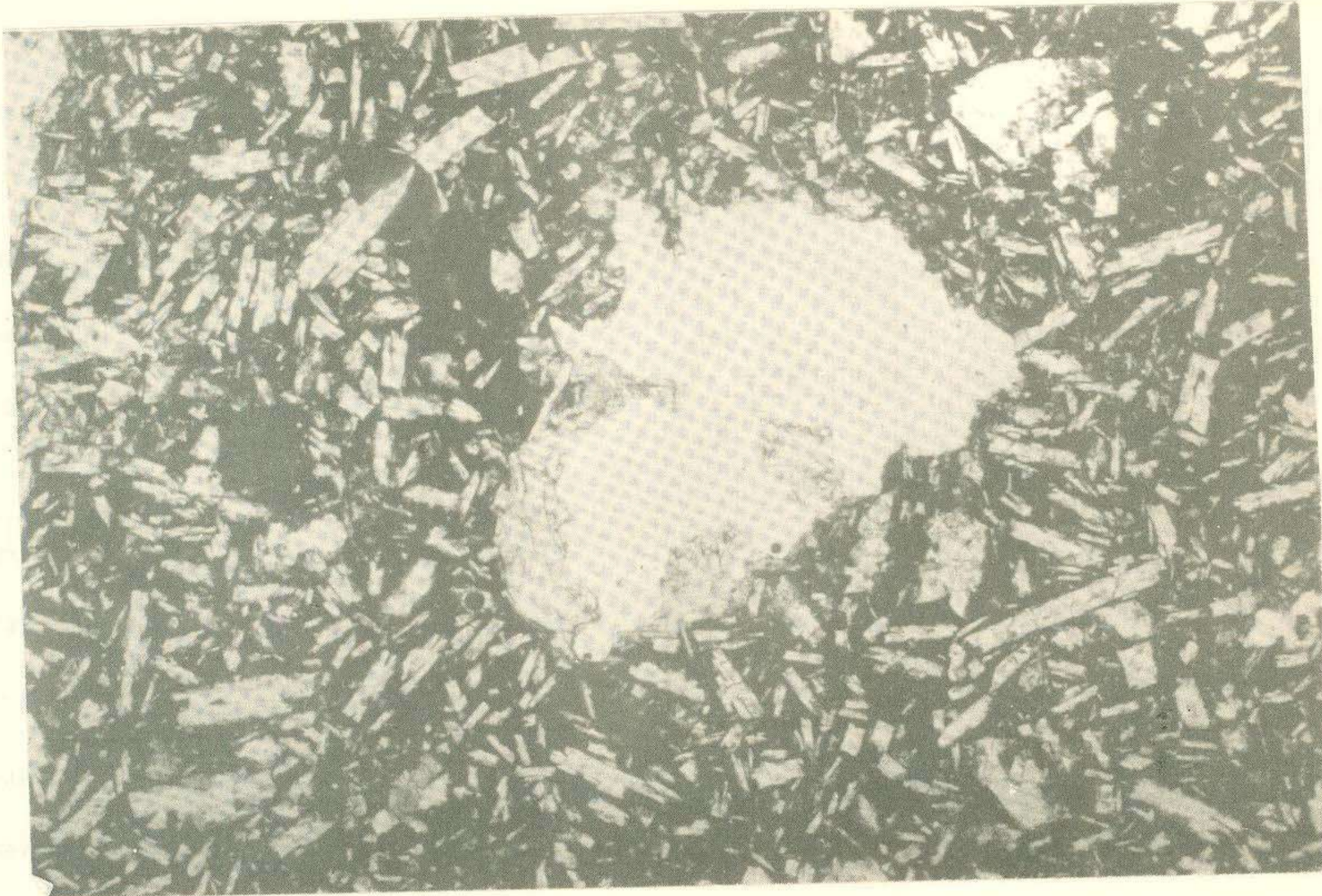
FIGURA 12. FOTOMICROGRAFIA DE BASALTO (25 X, LN)
