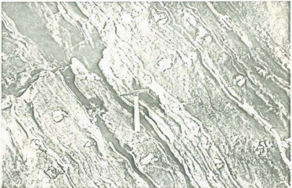
Foto 2.- Mármoles con intercalaciones finas de bandas calcosilicadas (gra-dio-epi) y nódulos de pedernal blanco. Fm. - Las Tierras (Cerro Peyote).
