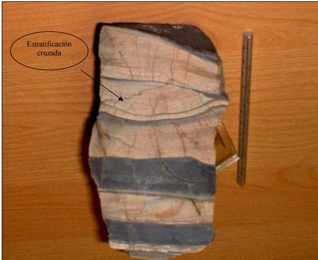
Figura 25.- Litofacies C. Estratificación flaser caracterizada por láminas cóncavas de lutita dentro de arenisca con estratificación cruzada.
