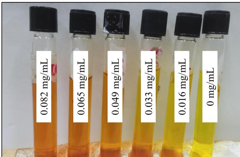
**Figura 6.** Estándares de glucosa con DNS utilizando concentraciones de 0.082, 0.065, 0.049, 0.033, 0.016 y 0.0mg/mL de glucosa. Los tubos con mayor intensidad de color naranja corresponden a los que contenían mayor concentración de glucosa.
