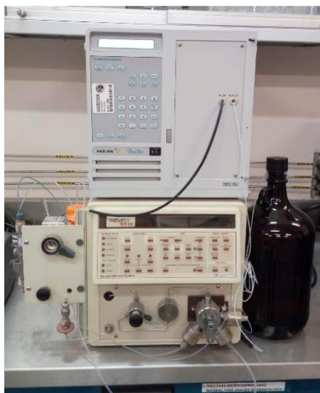
Figura 10. Cromatógrafo líquido de alto rendimiento (HPLC).
