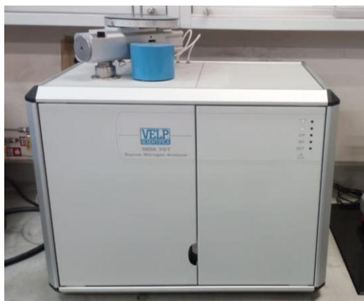
Figura 8. Analizador de nitrógeno DUMAS.
